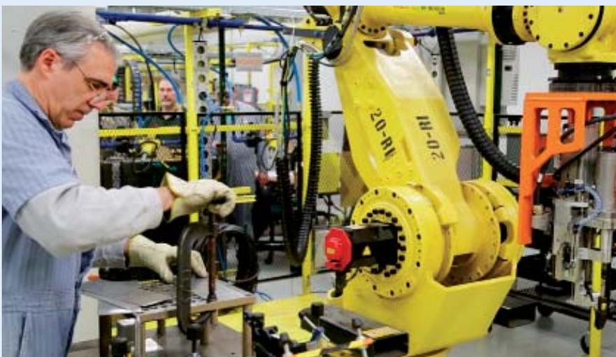
Beim Fügen der Vollaluminium-Karosserie des Pick-up-Trucks hat sich das Widerstandsschweißen mit komplexer Prozessführung und integrierter Elektroden-Instandhaltung bewährt.
