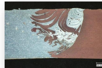
Reinaluminium mit Kupfer (3 mm dick)
